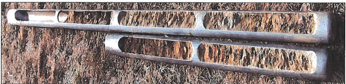
Abb. 3: Rammkernsondierung „RKS 1“ (Sonde unten: 0,00-1,00 m, Sonde oben: 1,00-2,30m)
