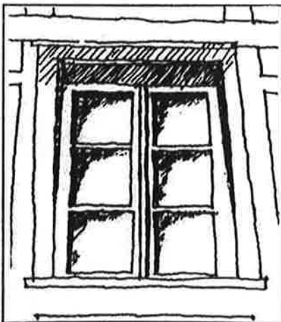
In Fachwerkhäusern sind Fensteröffnungen durch Holzbalken gerahmt
